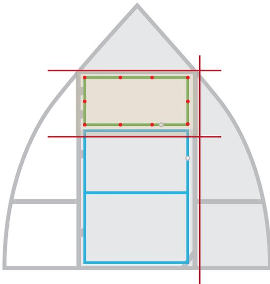
6. Выровняйте поликарбонат по вертикальной стойке на стороне петель с нахлестом поверх поликарбоната двери и закрепите.
