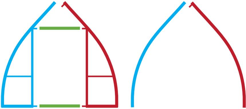
2. Закрепите двумя шурупами каждое соединение. Шурупы торцов должны находиться внутри теплицы, для этого при соединении расположите детали зеркально. Детали дуг располагайте одинаково.
