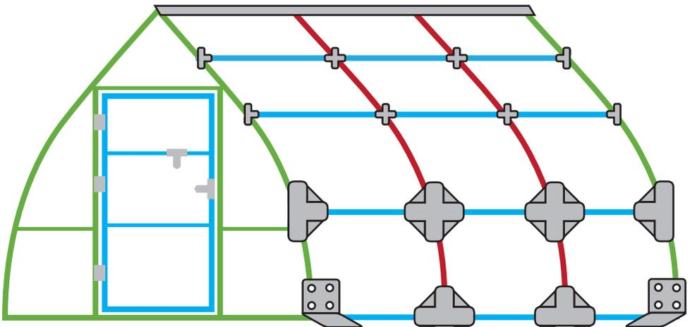
4. Вдоль каркаса закрепите внахлест маленькими саморезами верхние пластины.
